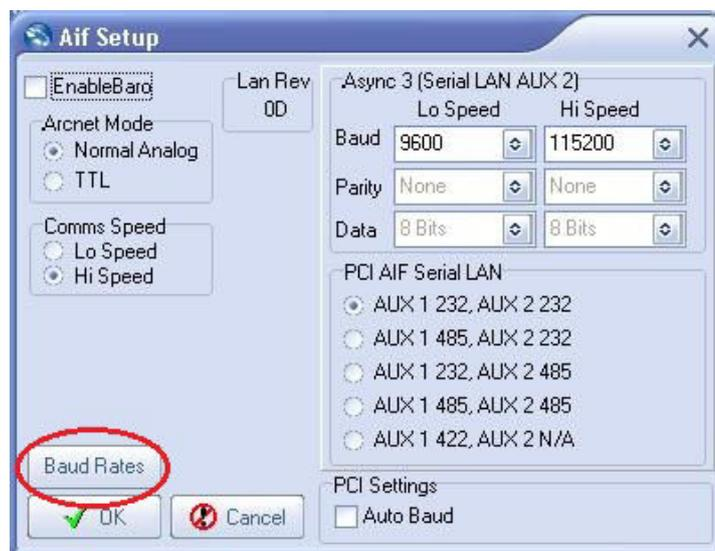
**Figure 4.10. AIF PCI Baud Rates Button**
